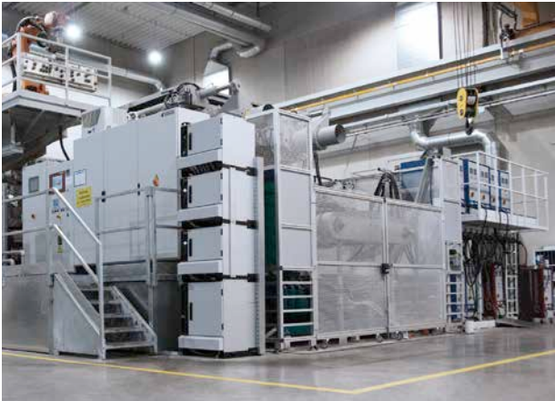
Bild 3: 2800 t-Druckgießmaschine in der neuen Gießereihalle.
