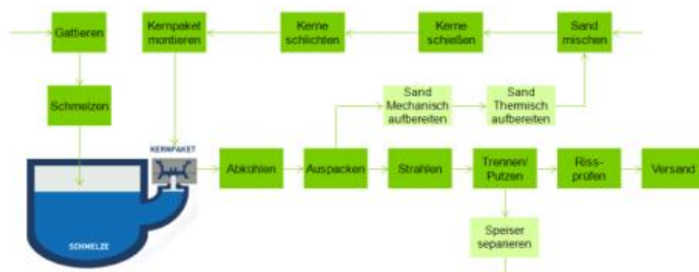
Prozessschritte (geplante Teile aus Edelstahl; niedrig legierte Teile extern strahlen/putzen)
